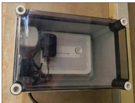
Fig. 2 – Evitare di installare il cavo di alimentazione sopra l'antenna incorporata
