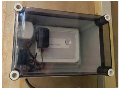
Abbildung 2 – Stromkabel möglichst nicht über der integrierten Antenne verlegen.
