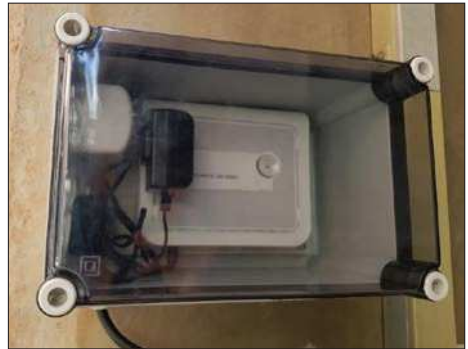
Fig. 2 – Evite instalar o cabo de alimentação na parte superior da antena embutida
