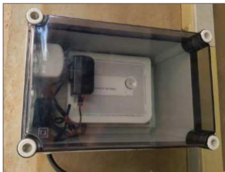
Рис. 2 — Не устанавливайте кабель питания поверх встроенной антенны.
